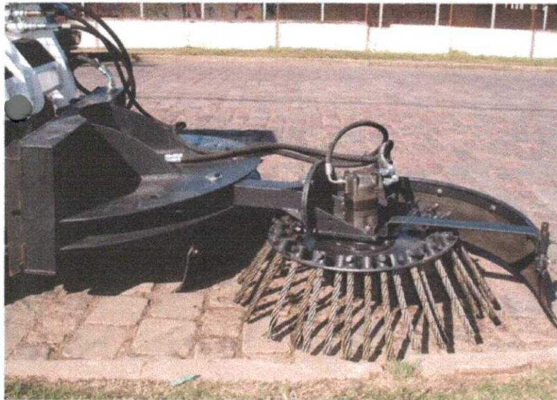
O acessório é facilmente instalado através do sistema de engates rápidos da carregadeira.
